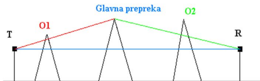
Slika 10.12 - ITU-R P.526-13 metod – „oštrice noža” u kaskadi
